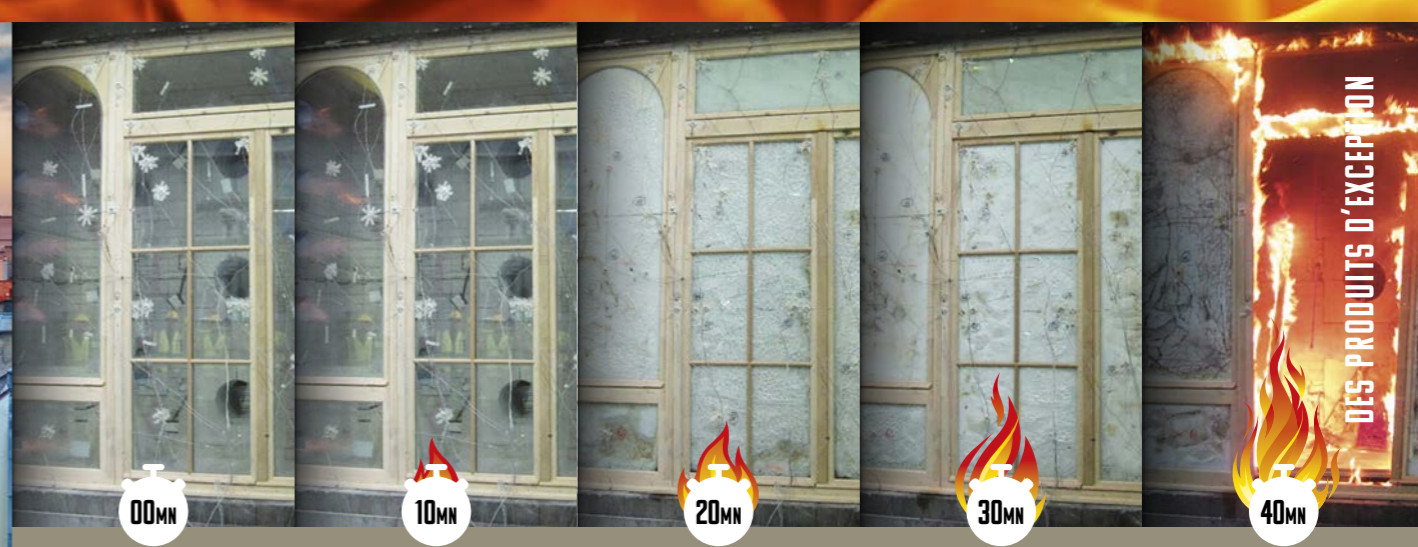
Test performance fenêtre coupe-feu 30mn norme EI30 Menuiserie LEVIEUX
